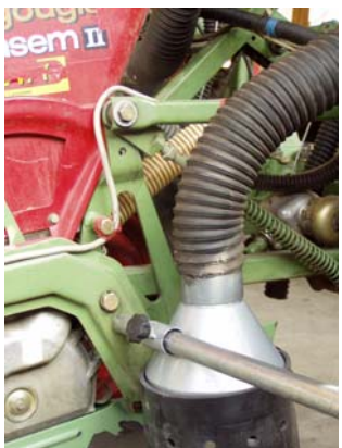
Montage des „Deflektor“ in richtiger Position – unmittelbar über dem Boden
