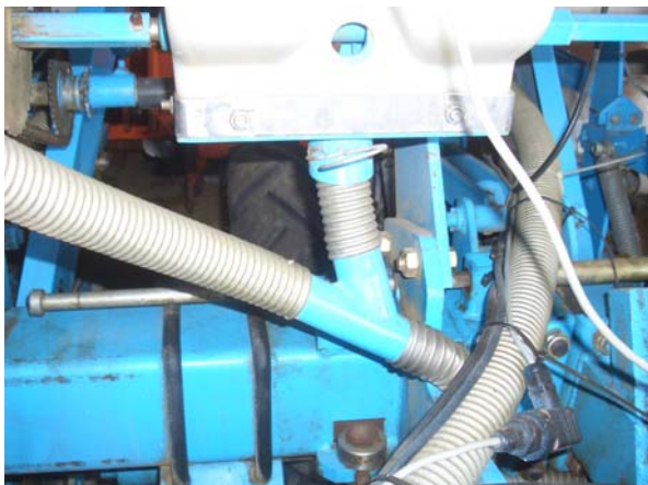
Links: Einspeisung der Gebläseabluft ins Düngersystem. (Foto Beat Wyss)
